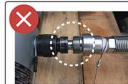
カプラー差込みの悪い例 ねじ部分に隙間あり
