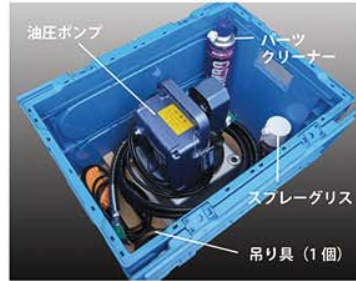
油圧ポンプ収納状態
